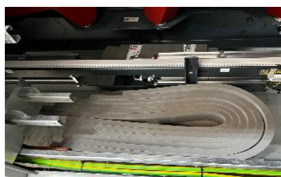
Bild 5-33: Dämmmatten im Gehäuse beigelegt
