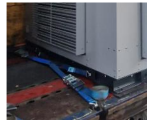
Bild 5-14: Ladungssicherung in Querrichtung
