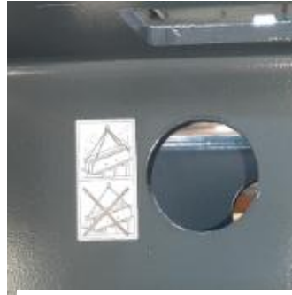
Bild 5-1: Kennzeichnung Hebeösen für Kranhaken
