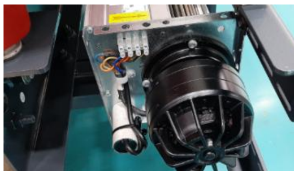
Bild 6-16: Strom-Anschluss für Lüfter am Motor (Beispiel)
