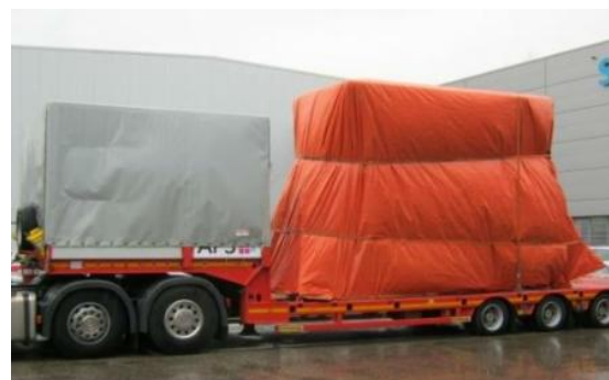
Bild 5-8: Verzurren des Transformators auf Ladefläche
