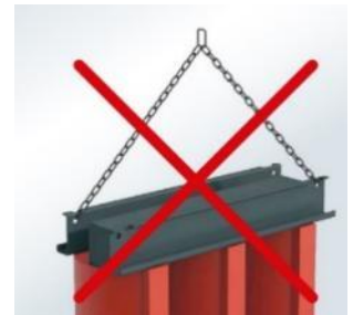
Bild 5-3: NICHT korrektes Anheben des Transformators
