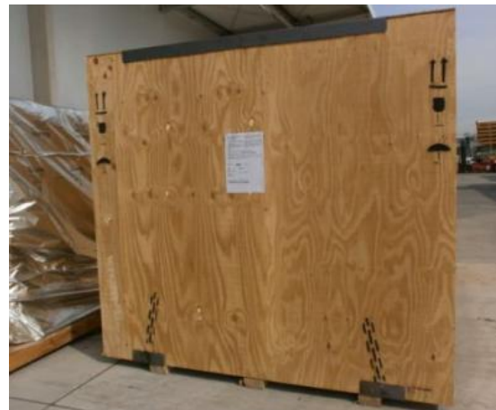
Bild 5-9: Kennzeichnung der Positionierung von Hebemitteln
