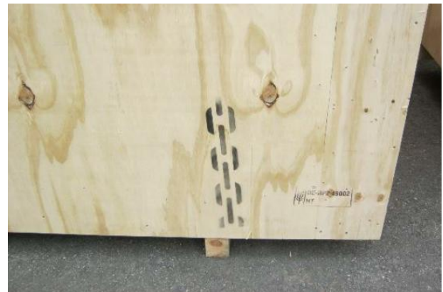
Bild 5-22: Kennzeichnung der Positionierung von Hebemitteln
