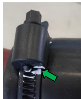
Bild 8-3: Position der Farbmarkierung auf Schelle nach dem Anziehen
