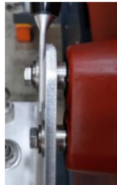
Bild 5-35: Anordnung der Unterlegscheiben auf Schaltrohre an OS-Anschluss
