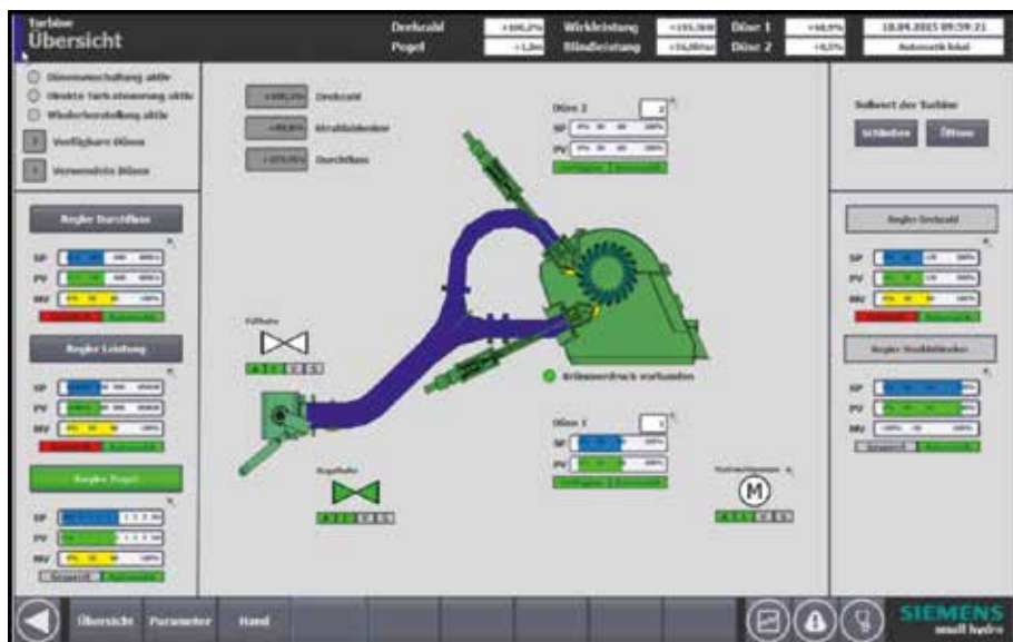
Oversikt over en peltonturbinenhet med to dyser og innløpsventil (skjerm bilde). Alle relevante settpunktverdier, parameterverdier og faktiske verdier vises og er tilgjengelige. Tilstanden til turbinkontrolleren visualiseres, siden flytregulering, kraftregulering, nivåregulering, og de tillatte driftsmodusene kan velges.
